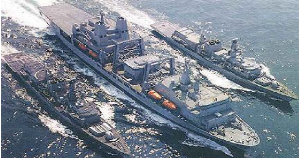
Figur 1 UNREP operasjon med AOR fartøyet RFA Fort Victoria(Naval Technology,2003)
